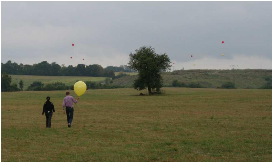
Für alle Ansichten wurden neue Fotos mit den Ballons erstellt und mit dem Modell verglichen. Da die Ballonmarkierungen auf die vermessene NN-Höhe ausgerichtet wurden, kann durch sie eine höhere Genauigkeit erreicht werden. Die Bildmontagen wurden darauf angepasst. Es ergaben sich Abweichungen von bis zu 2 m in der Höhe, die Relationen zwischen Variante 1 und 2 blieben jedoch unverändert.
