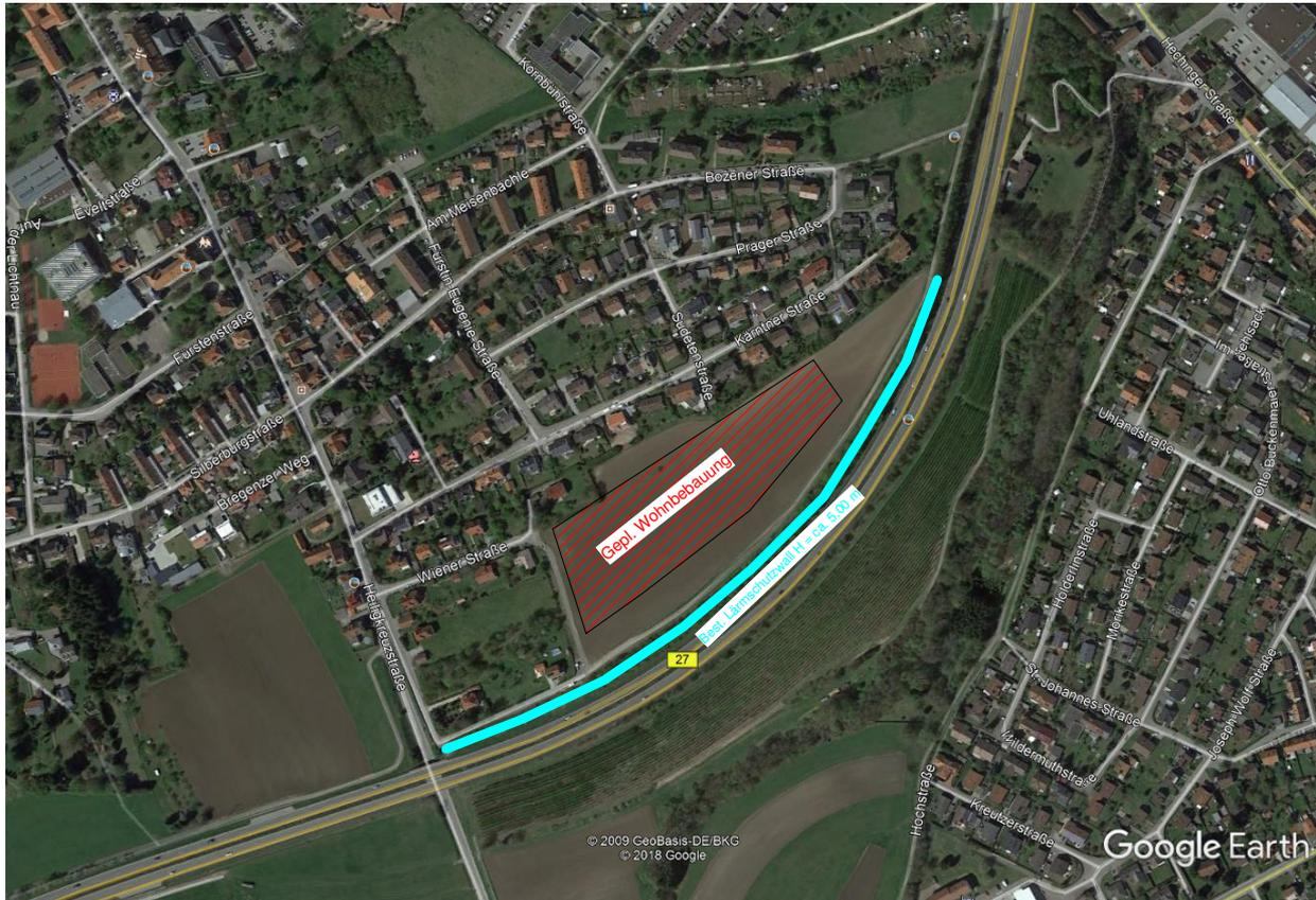
Als Abtrennung der vorhandenen Wohnbereiche ist entlang der B27 bereits ein Lärmschutzwall mit einer Höhe von ca. 5 m oberhalb der Straßenoberkante der B 27 vorhanden. Der Lärmschutzwall ist stark bewachsen. Die bebaubare Fläche fällt in Nord-Östlicher Richtung leicht ab.
